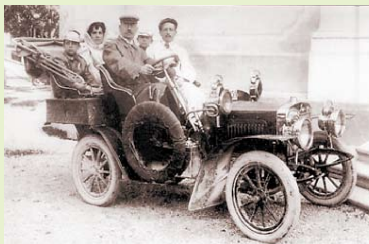
L&K Type B с ацетиленовыми фарами, багажными корзинами и запасным колесом подготовлен для дальнего путешествия.
